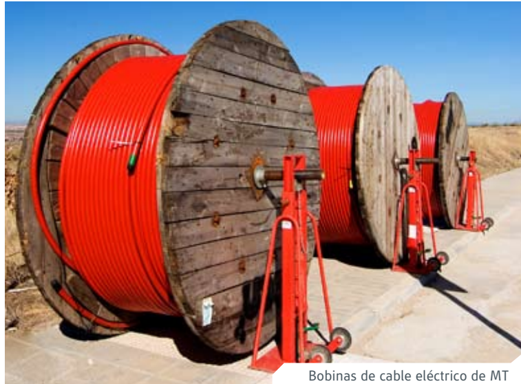
Bobinas de cable eléctrico de MT
